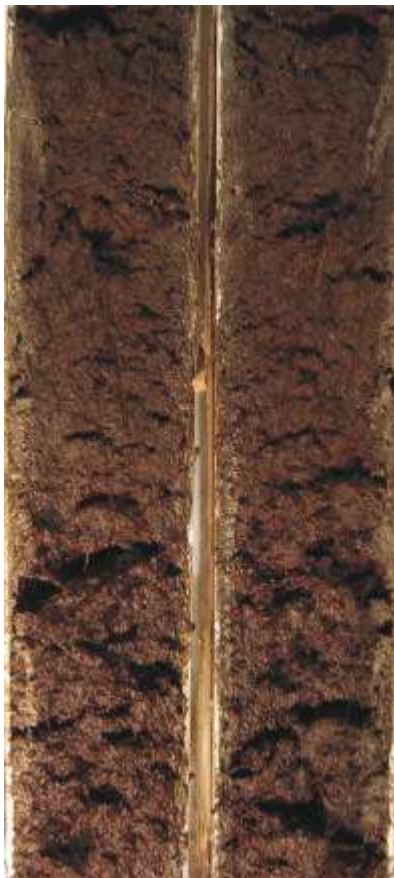
Figura 24. Turfa "leve ou fibrosa" a "escura ou hêmica" em testemunho coletado em sondagem com vibrotestemunhador no PECE (S01-UTM 215638N/7271581E) (Sallun et al. 2008)
