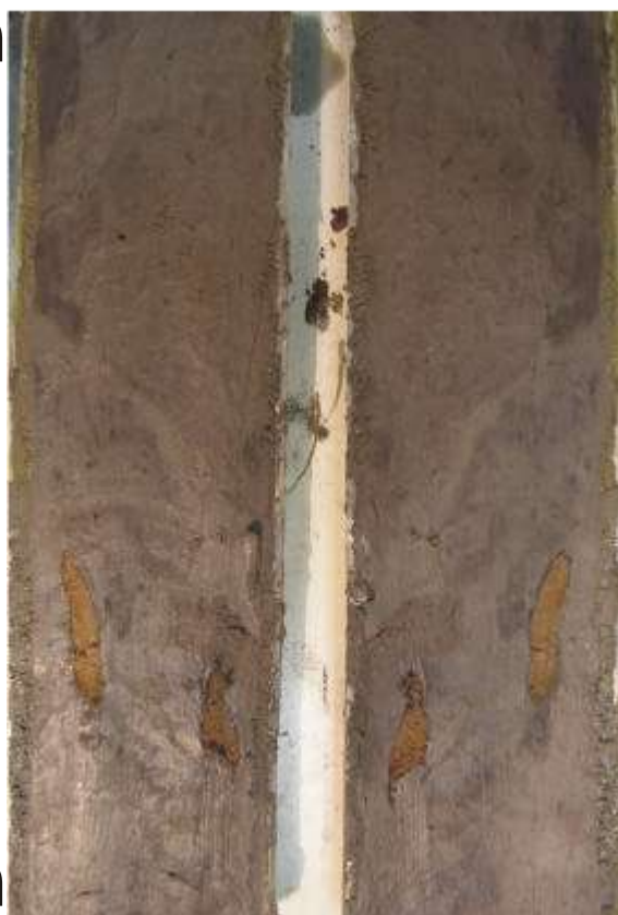
Figura 27. Sedimentos argilosos paleolagunares com fragmentos vegetais bem preservados, que ocorre abaixo da turfeira em testemunho coletado em sondagem com vibrotestemunhador no PECE (S01-UTM 215638N/7271581E) (Sallun et al. 2008)
