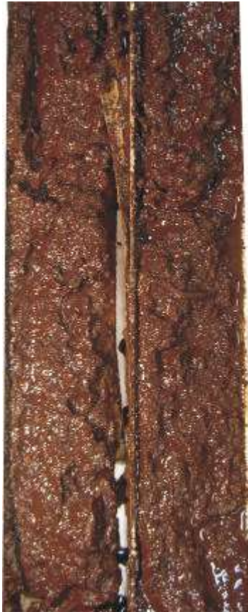
Figura 25. Turfa "preta ou sáprica" em testemunho coletado em sondagem com vibrotestemunhador no PECE (S01-UTM 215638N/7271581E) (Sallun et al. 2008)
