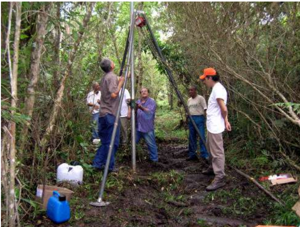
Figura 20. Sondagem com vibrotestemunhador na Trilha da Campina do Parque Estadual da Campina do Encantado para coleta de amostras de turfeira para pesquisa científica do Instituto Geológico (IG/SMA-SP) (S01-UTM 215638N/7271581E) (Sallun et al. 2008)
