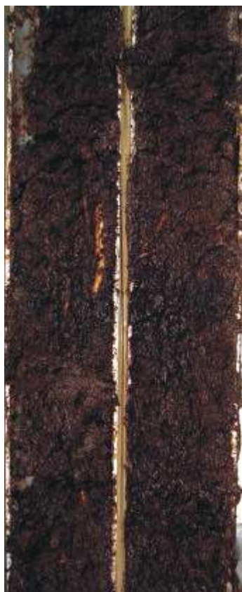
Figura 28. Turfa "preta ou sáprica" em testemunho coletado em sondagem com vibrotestemunhador no PECE (S02-UTM 218320N/7272114E) (Sallun et al. 2008)
