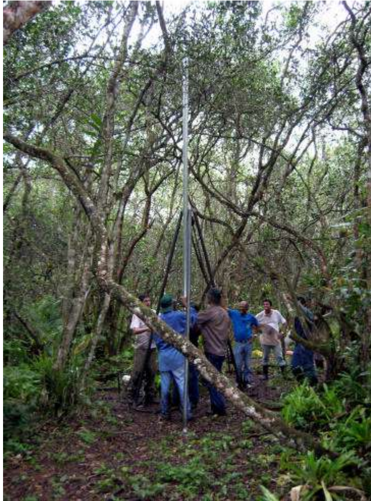
Figura 21. Sondagem com vibrotestemunhador na Trilha da Campina do PECE para coleta de amostras de turfeira para pesquisa científica do Instituto Geológico (IG/SMA-SP) (S02-UTM 218320N/7272114E) (Sallun et al. 2008)
