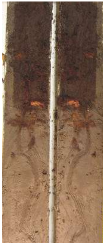
Figura 26. Turfa em testemunho coletado em sondagem com vibrotestemunhador no PECE (S01-UTM 215638N/7271581E) em contato com sedimentos argilosos paleolagunares (Sallun et al. 2008)
